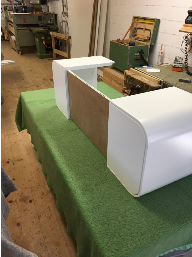
Bild 10: So habe ich das Möbel zusammengesteckt, um die Doppel auf der Rückseite anzuschrauben.
