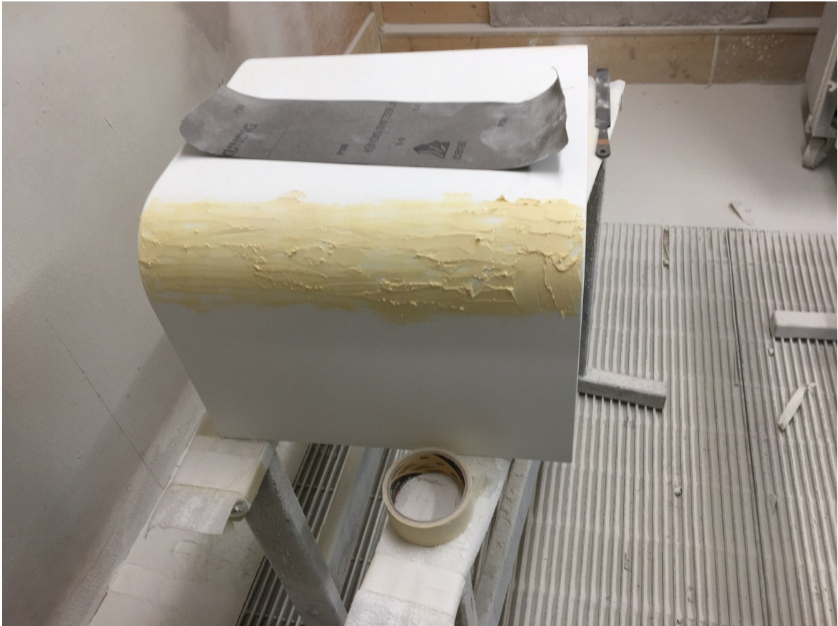
Bild 9: So habe ich die Rundungen nach dem Füllern nochmals gespachtelt, um alle Holzstrukturen auszufüllen.
