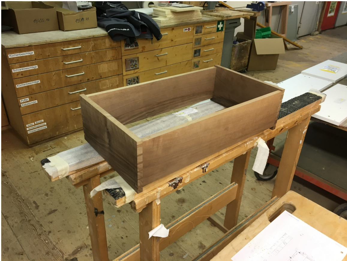
Bild 4: Die fertige Schublade mit den Schwalbenschwanz-Zinken
