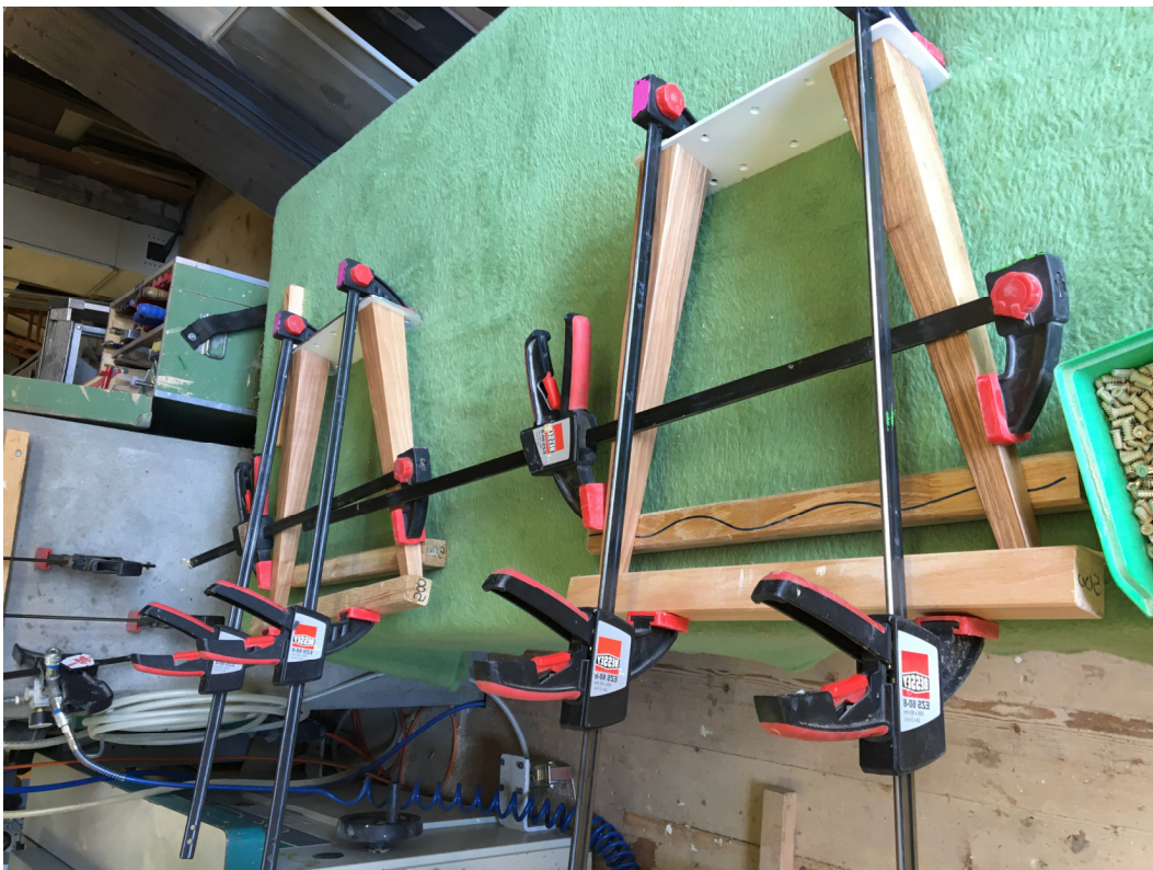
Bild 17: So habe ich die fertigen Beine an die Beschläge geleimt.
